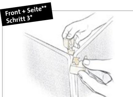
**Außen- und Innenhalter der Eckverbinder** in die Öffnung zwischen Front- und Seitenteil setzen und an die gewünschte Position schieben (ca. 10-15 cm von oben)
