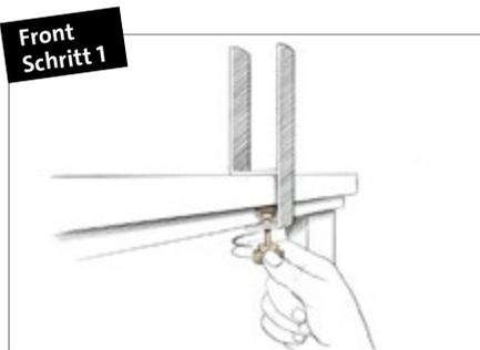
**Tischklammerpaar** mittels vormontierter Rändelschraube am Tisch anbringen. Wir empfehlen 10-15 cm vom Rand.
