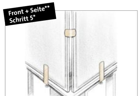
**Ansicht** nach Installation einer Eckverbindung
