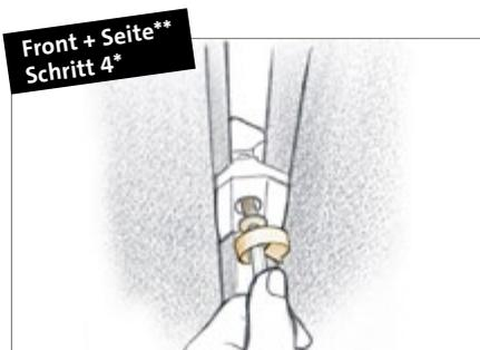
**Außen- und Innenhalter des Eckverbinders** an gewünschter Position mit Ibusschlüssel festdrehen
